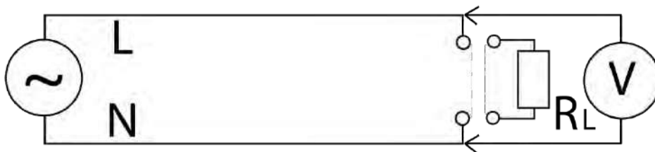
Πειραματικός προσδιορισμός πτώσης τάσης χρησιμοποιώντας δοκιμαστικό φορτίο R μεγάλο- μέτρηση
